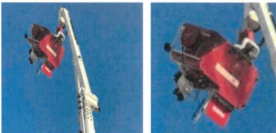
Les parties télescopiques du bras principal se sont brutalement reployées : descente d'environ 12 mètres. Le choc a notamment provoqué le basculement de la nacelle vers l'avant et l'ouverture du portillon.
